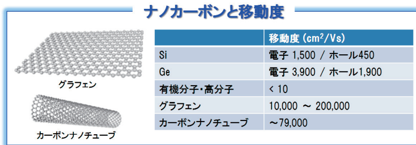
図1 グラフェンとカーボンナノチューブの構造と移動度の比較。
